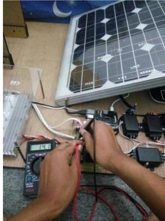
**Gambar 13. Pengukuran pada beban 25%**
